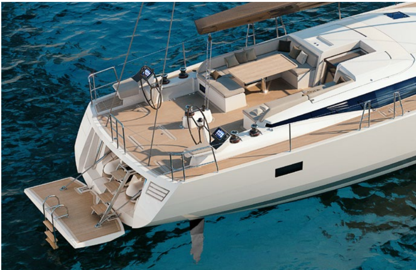
Cockpit asymétrique et pont arrière de plain-pied. Asymetric cockpit flush with aft deck.
